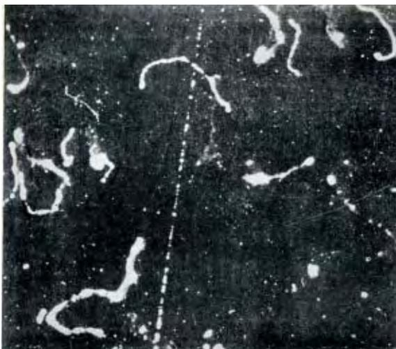
Fotografia di un elettrone veloce in camera di Wilson immersa in un forte campo magnetico. A destra, traccia di una particella che urta un elettrone che viene sbalzato in avanti percorrendo una traiettoria quasi circolare. Le figure sono tratte dalla Prima Conferenza di Fisica Atomica tenuta da Enrico Fermi nell'aula dell'Istituto fisico dell'Università di Roma, 3 ottobre 1949.
